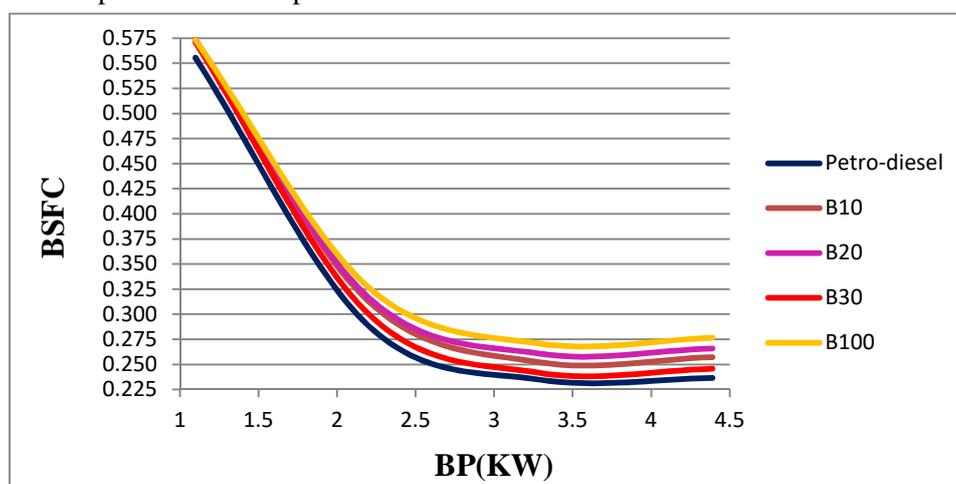
**Graph 1.7 SHOWS BSFC (BRAKE SPECIFIC FUEL CONSUMPTION) CURVE VS BP (BRAKE POWER)**
