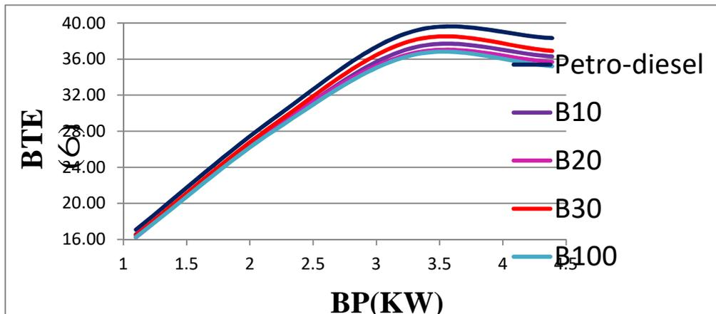
**Graph 1.8 SHOWS BTE (BRAKE THERMAL EFFICIENCY) CURVE VS BP (BRAKE POWER)**
