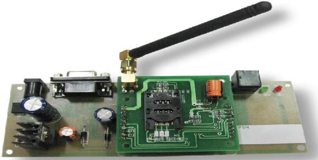
**Fig 6 : GSM Module**
