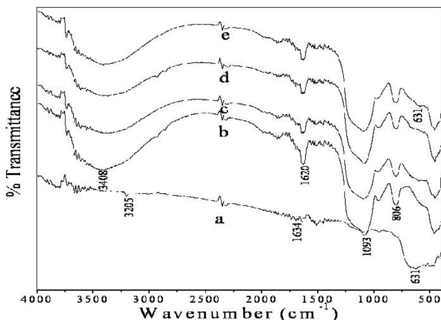
Figure 5 (a-c) FT-IR patterns of (a)  $\text{SnO}_2$  (b)  $\text{SiO}_2$  (c) 10 wt %  $\text{SnO}_2/\text{SiO}_2$  (d) 15 wt %  $\text{SnO}_2/\text{SiO}_2$  (e) 20 wt %  $\text{SnO}_2/\text{SiO}_2$
